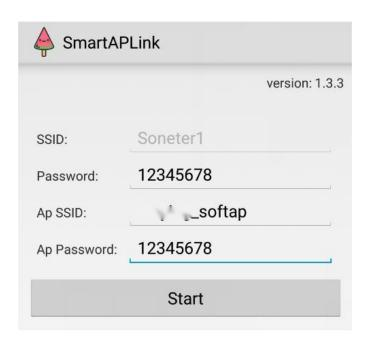
4.4 APP 自动完成扫描并连接到 DR16x AP 热点,发送路由器配置信息,重启 DR16x,重连到原先路由器,并发现设备的功能 (IOS 版本此切换 Wi-Fi 热点的过程需要手动操作)。
