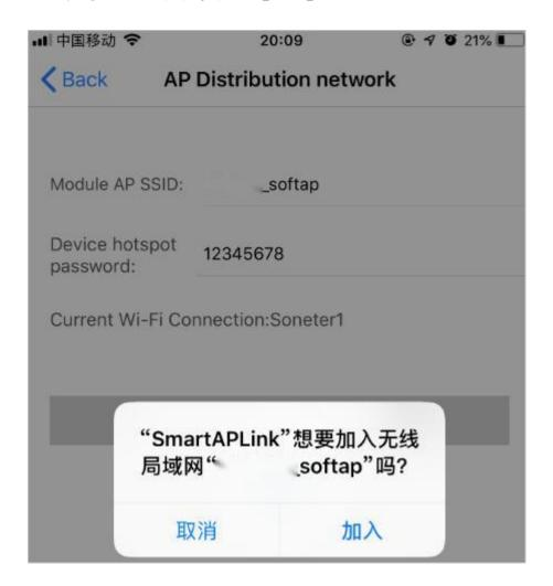
5、发送配置信息完成,点击【To Scan】 切换回原来路由器。
