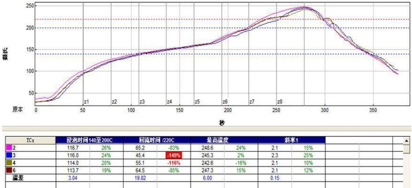
图 6 回流焊焊接温度曲线图
