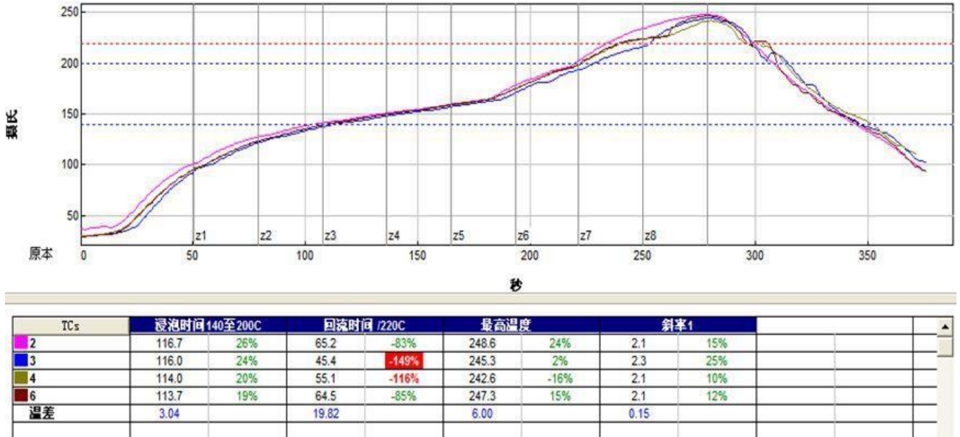
图片8 回流焊焊接温度曲线图
