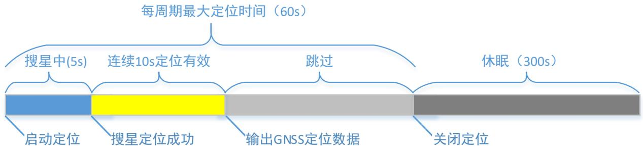
图 1 周期模式定位成功流程
