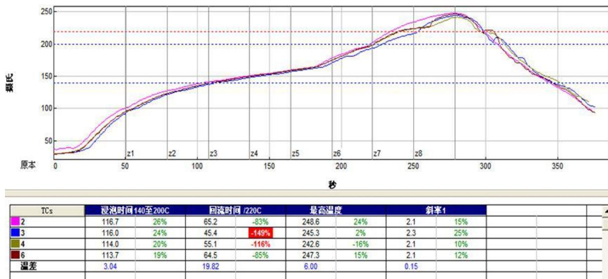
图片15 回流焊焊接温度曲线图
