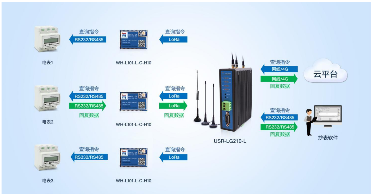
图 15 Modbus 抄表系统示意图
