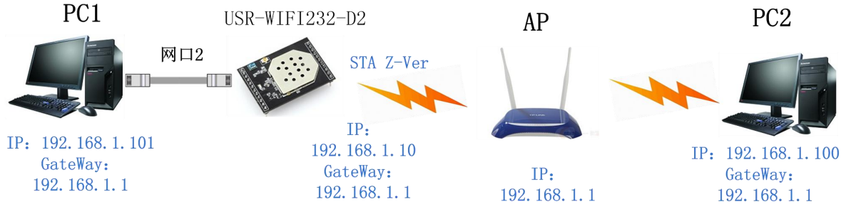
图 25 USR-WIFI232-D2 以太网接口功能（STA Z-Ver）
