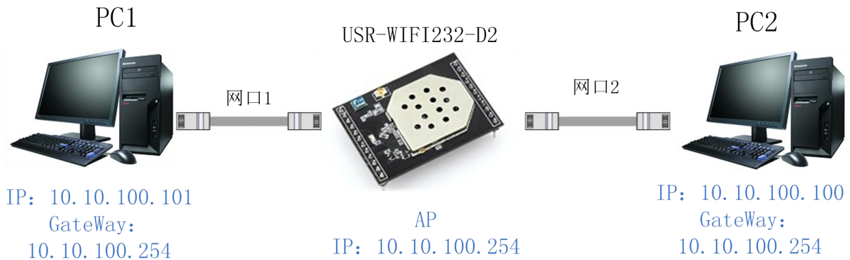
图 23 USR-WIFI232-D2 以太网接口功能（AP+双网口）
