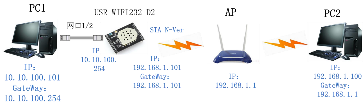
图 24 USR-WIFI232-D2 以太网接口功能（STA N-Ver）
