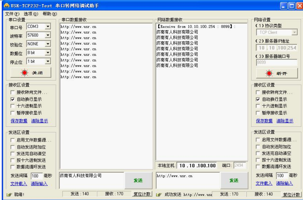
图 55 网络转串口测试结果显示
