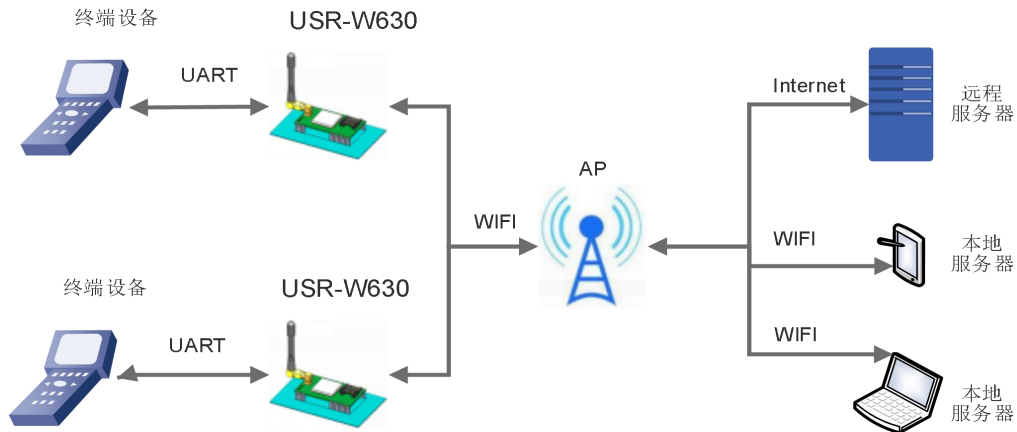
图 2 串口服务器作为 STA 的应用场景
