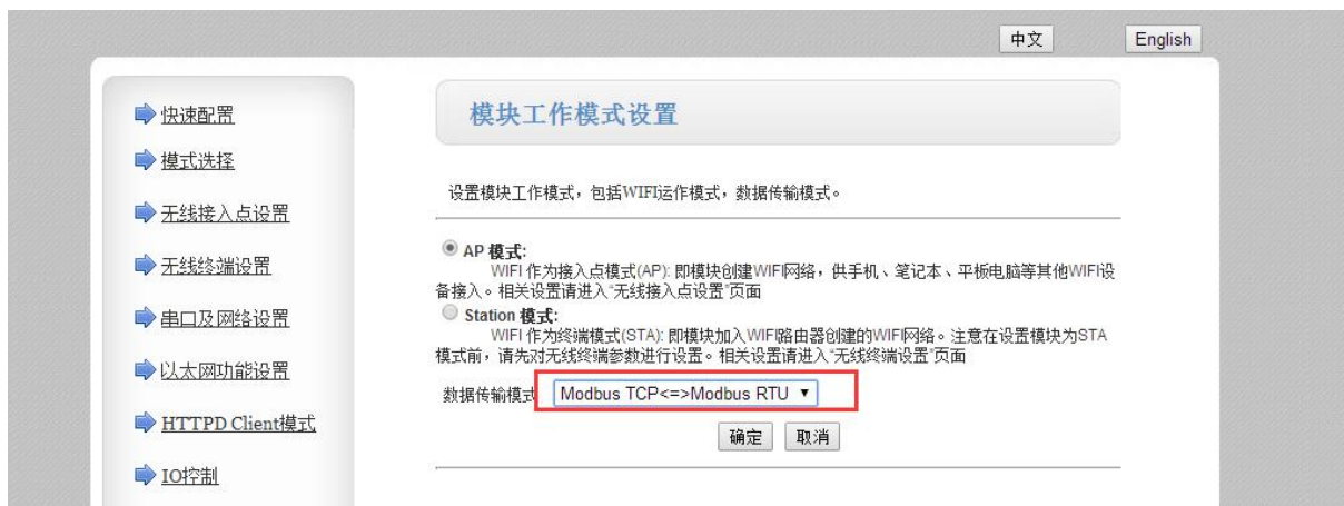
图 16 网页设置 Modbus RTU<=>Modbus TCP
