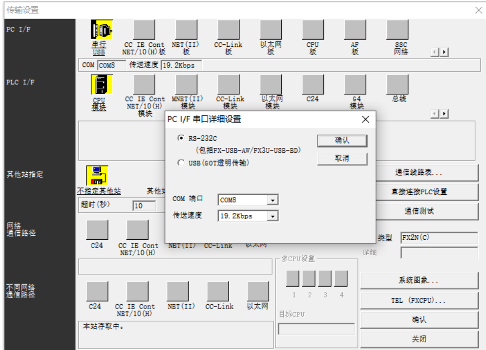
图 7 编程软件连接设备
