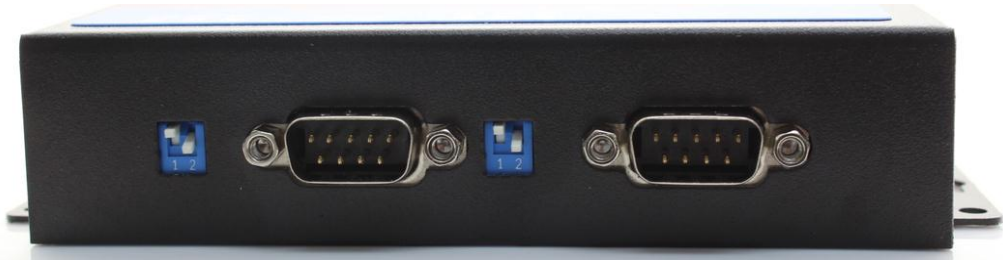
图 13 拨码开关 RS422 状态
