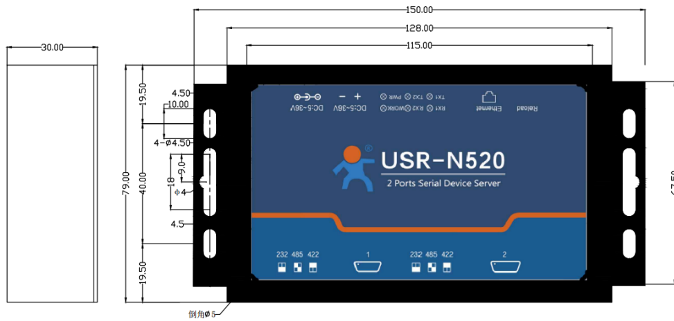
图 8 520 尺寸图-前面板
