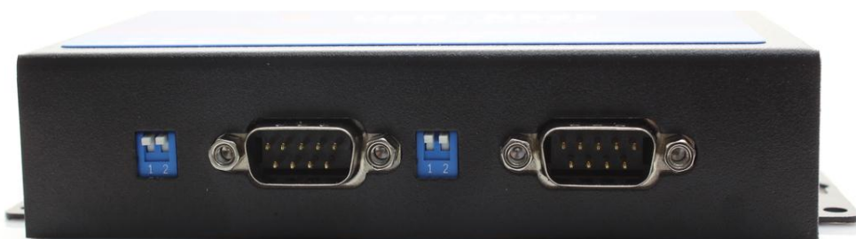
图 11 拨码开关 RS232 状态
