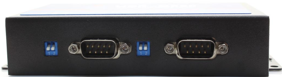
图 11 拨码开关 RS232 状态
